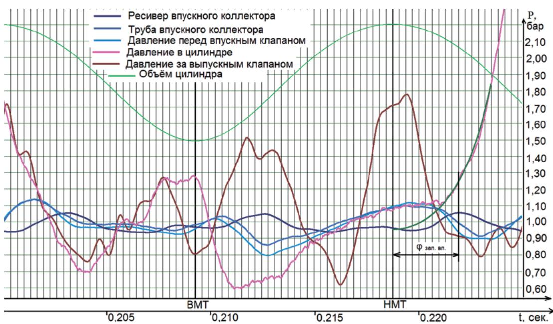
*Рисунок 6.* Графики давления в процессе газообмена двигателя ВАЗ-2112: н — 3 200; ДЗ — 100 %
