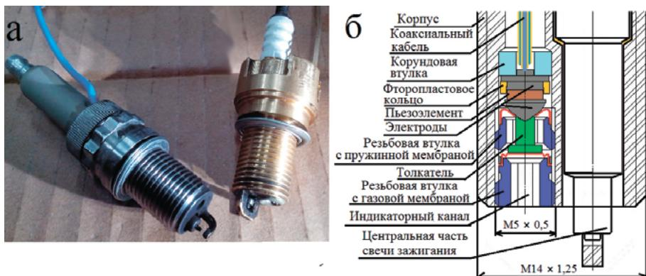
Рисунок 2. Фотография и схема опытного образца датчика-свечи, разработанного в ПЛТД МАДИ
