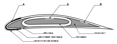
Самый распространенный дефект в лопасти - отслоение заполнителя от лонжерона Б или обшивки В. Данные дефекты выявляются только методом свободных колебаний.
